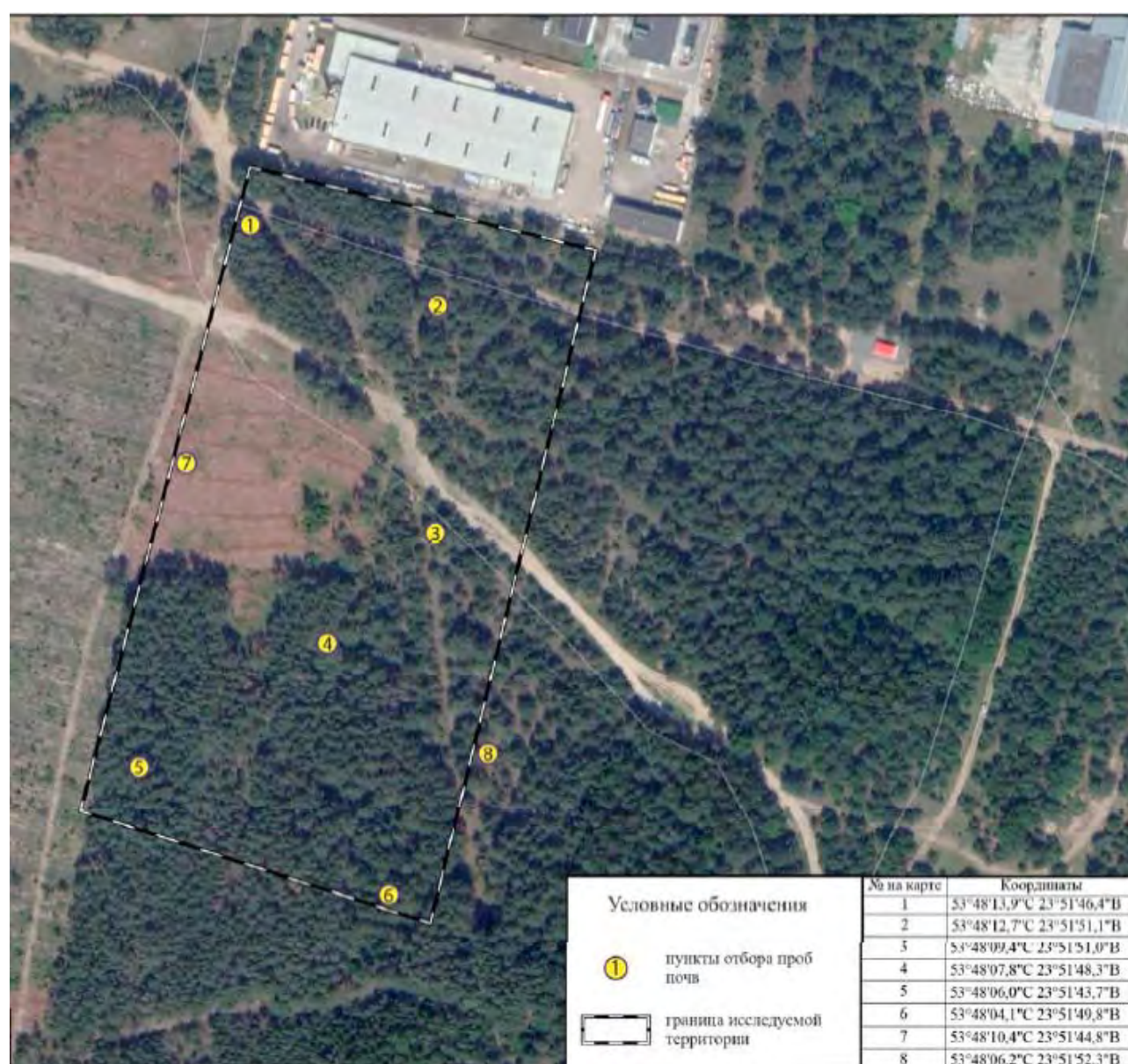
Рисунок 4.1.5.3 – Схема отбора проб почв на участке строительства
