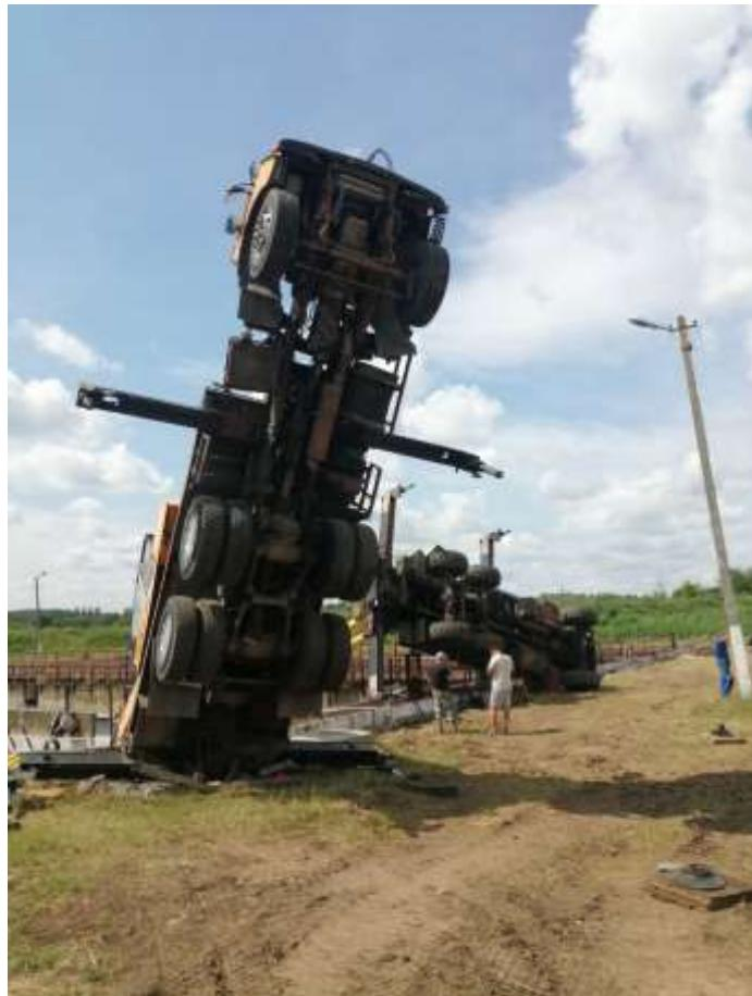
**11.07.2023 в 15:00** на территории технического участка СУП «Полесье-Промжилстрой» (д. Лубня Мозырского района Гомельской обл.) при проведении погрузочно-разгрузочных работ произошло опрокидывание крана стрелового самоходного КС-55727-7.
