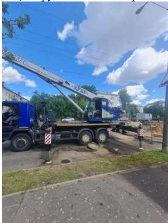
**18.09.2023 в 14:00** произошло падение двух рабочих ДУП «ПМК-201» УП «Минскоблсельстрой» с самодельной платформы, навешенной на крюк автомобильного крана КС-5576Б и поднятой на высоту около 6 м для выполнении монтажа водосточной системы
